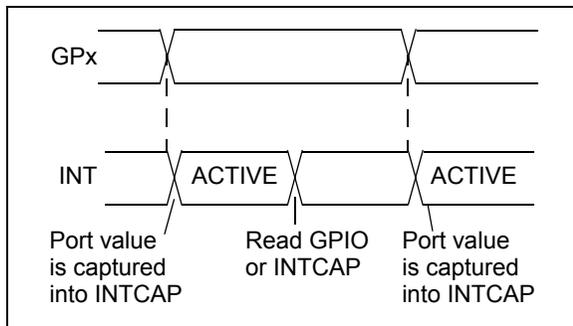
**FIGURE 1-7: INTERRUPT-ON-CHANGE FROM REGISTER DEFAULT**
